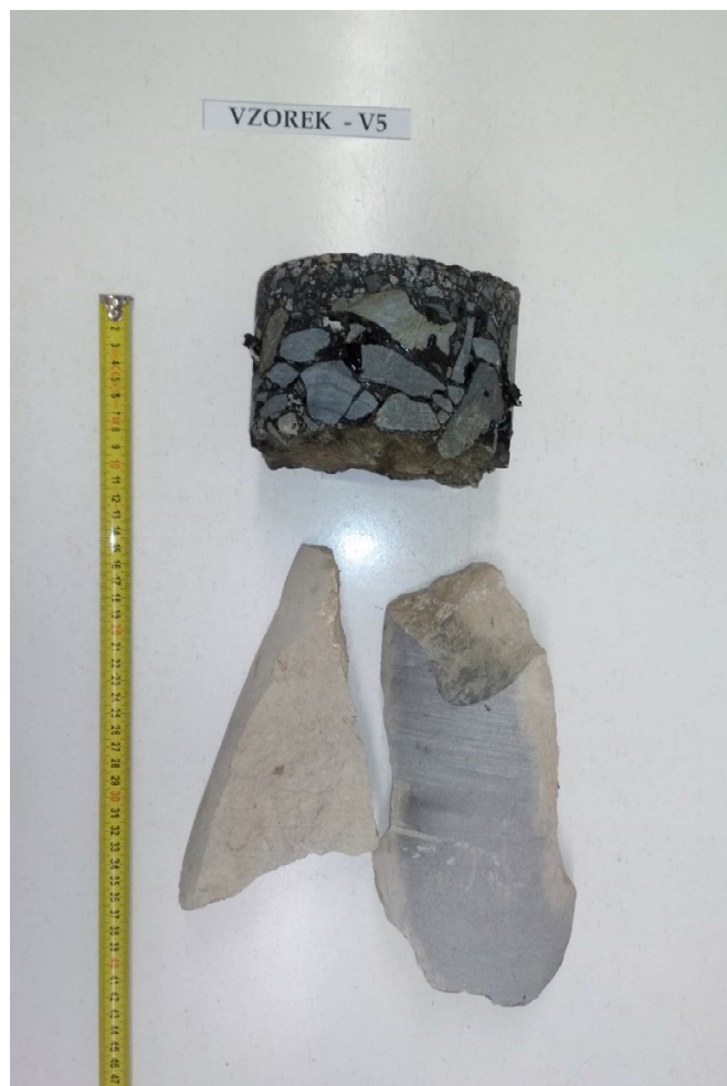
Obr. 10 Jádru vývrtu Vzorek – V5 (laboratoř).
