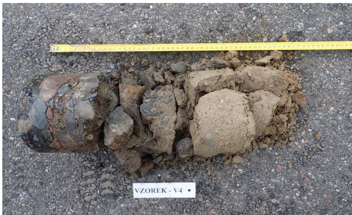
Obr. 7 - Jádro vývrtu Vzorek – V4 (in situ).
