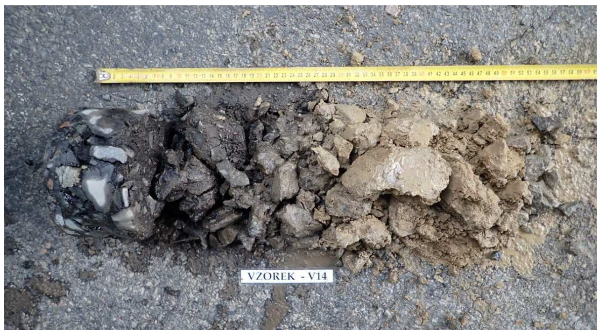
Obr. 27 - Jádro vývrtu Vzorek – V14 (in situ).
