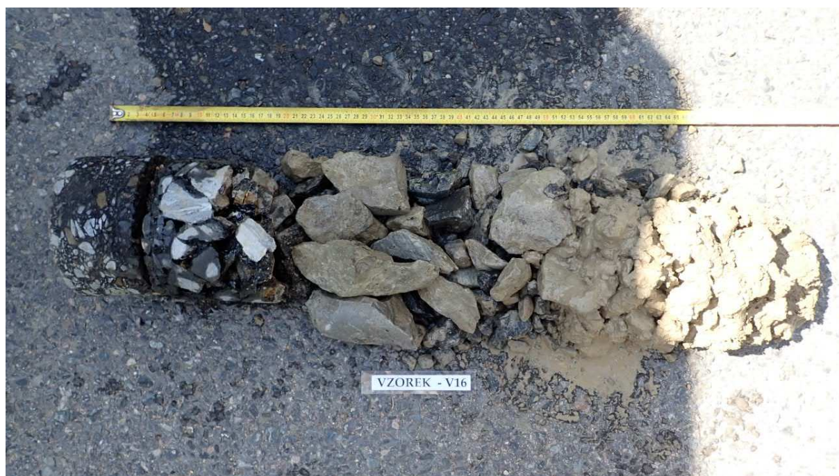
Obr. 31 - Jádro vývrtu Vzorek – V16 (in situ).
