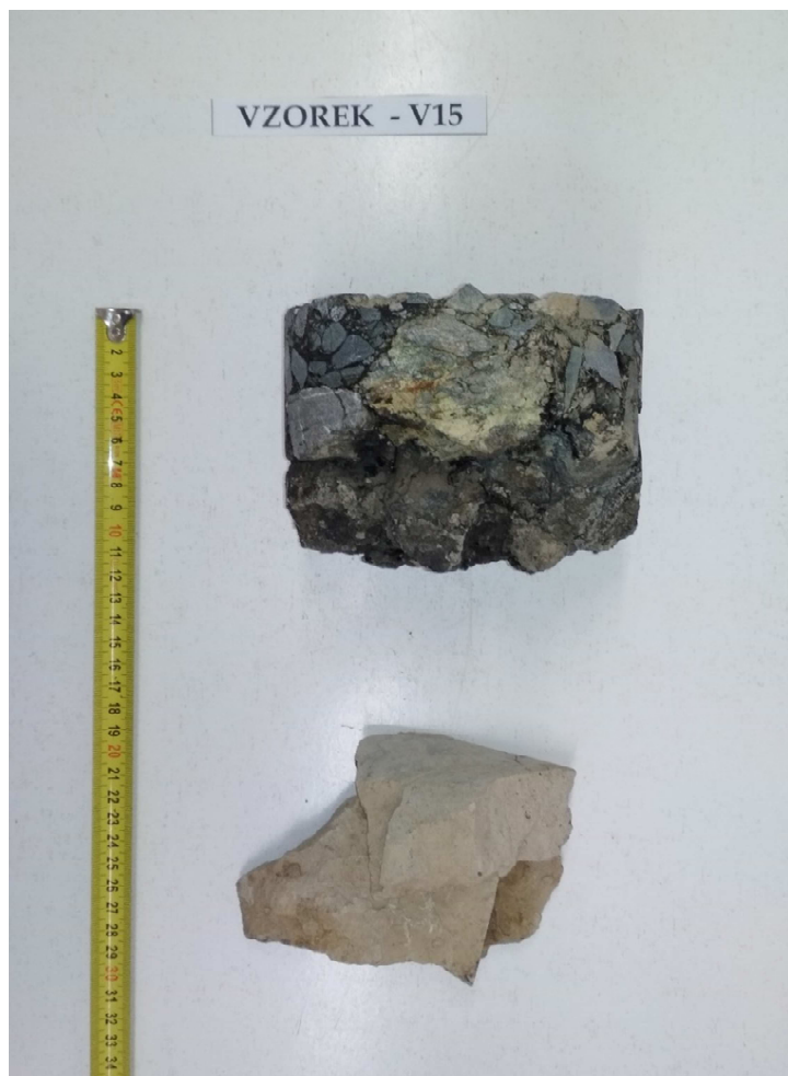
Obr. 30 - Jádru vývrtu Vzorek – V15 (laboratoř).
