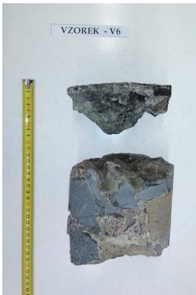
Obr. 12 - Jádro vývrtu Vzorek – V6 (laboratoř).
