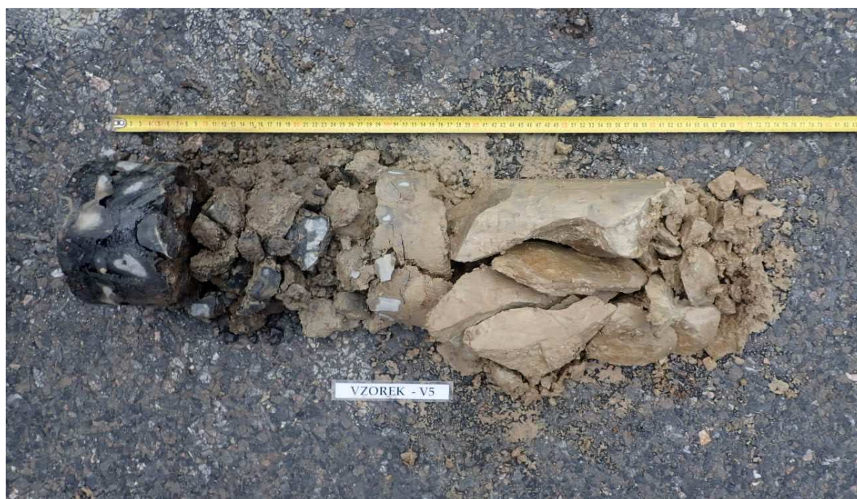
Obr. 9 - Jádro vývrtu Vzorek – V5 (in situ).
