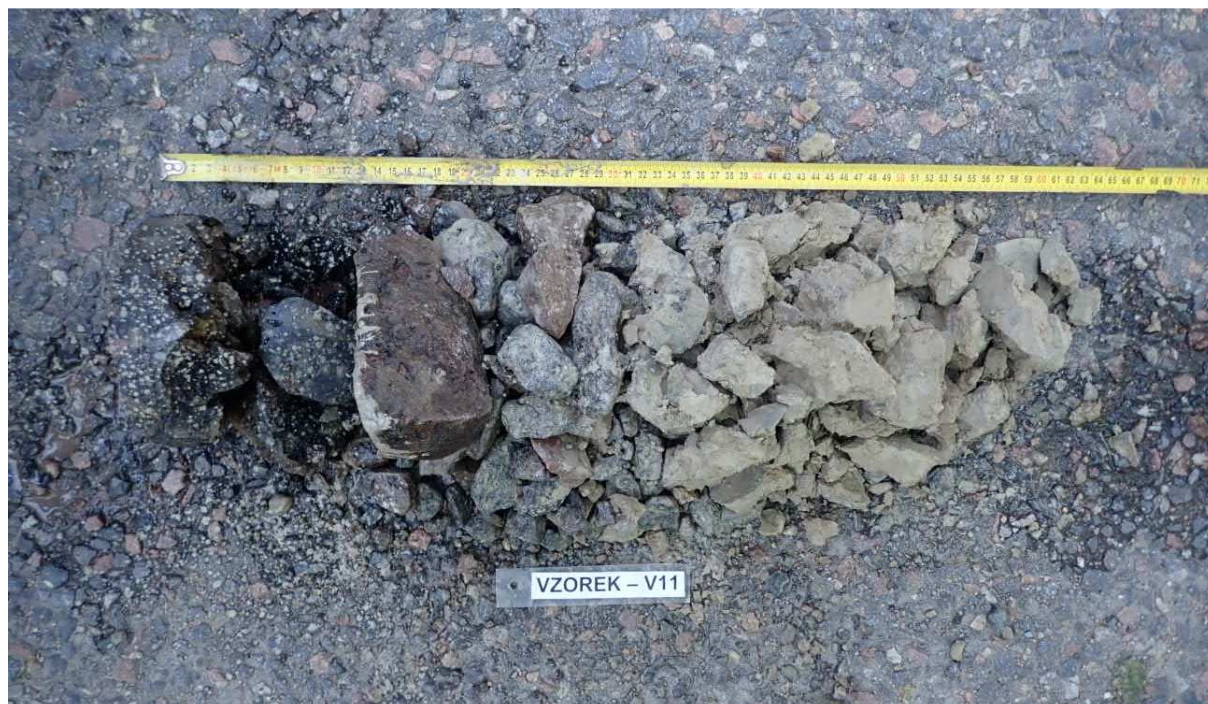
Obr. 21 - Jádro vývrtu Vzorek – V11 (in situ).
