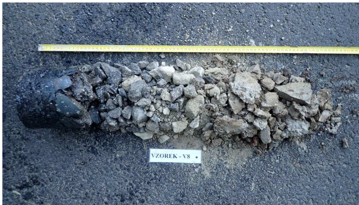
Obr. 15 - Jádru vývrtu Vzorek – V8 (in situ).
