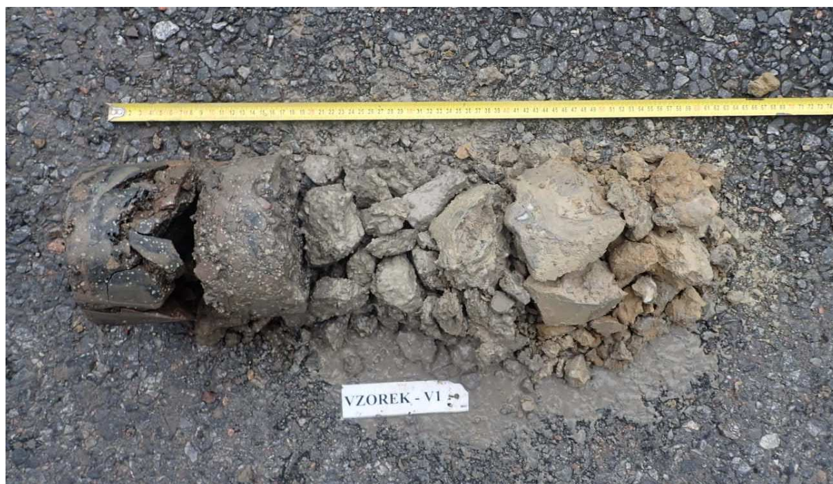
Obr. 1 - Jádru vývrtu Vzorek – V1 (in situ).
