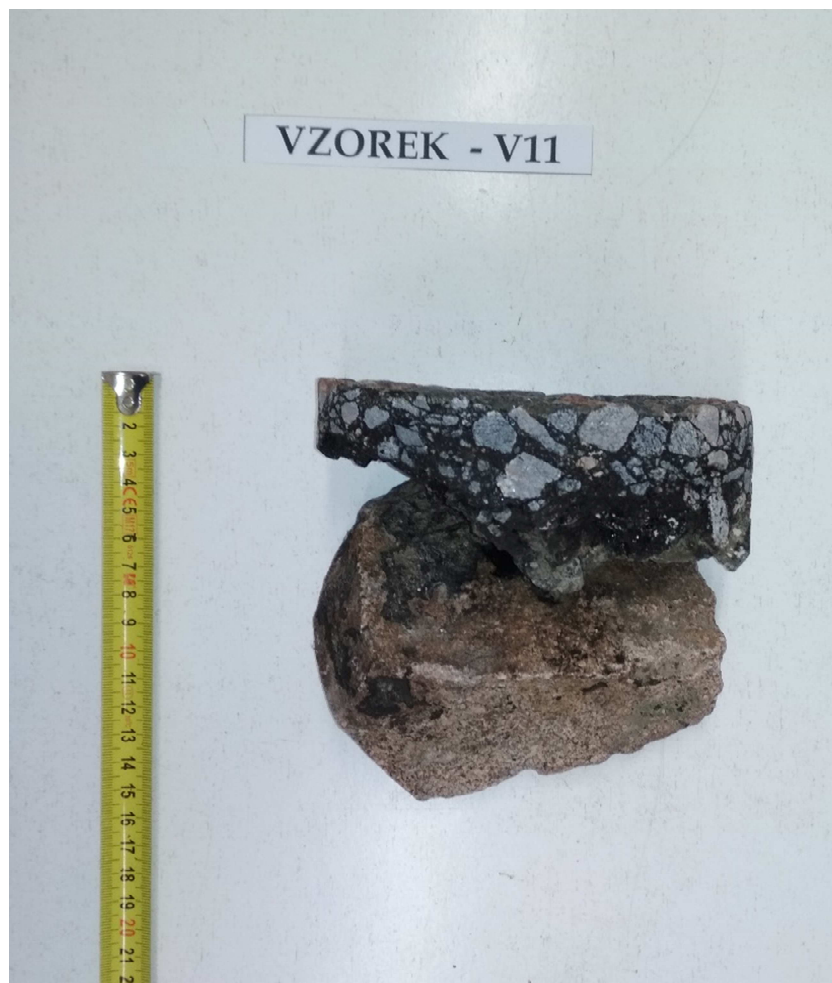
Obr. 22 - Jádru vývrtu Vzorek – V11 (laboratoř).
