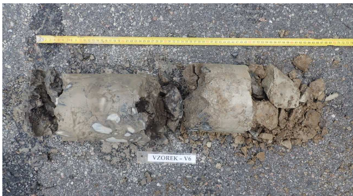
Obr. 11 - Jádru vývrtu Vzorek – V6 (in situ).
