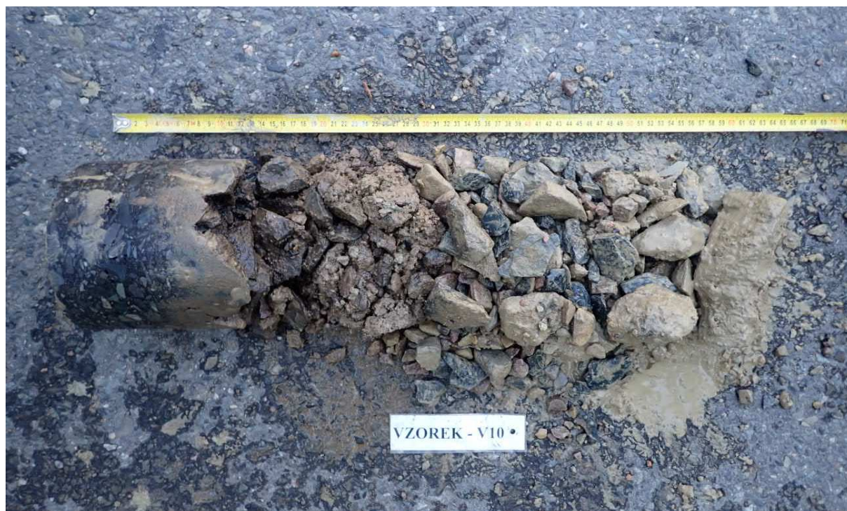
Obr. 19 - Jádro vývrtu Vzorek – V10 (in situ).
